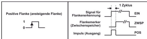
Netzwerk 1: Auswertung einer steigenden Flanke
